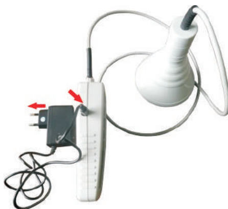
Рис.4 Подключение адаптера питания к аппарату
