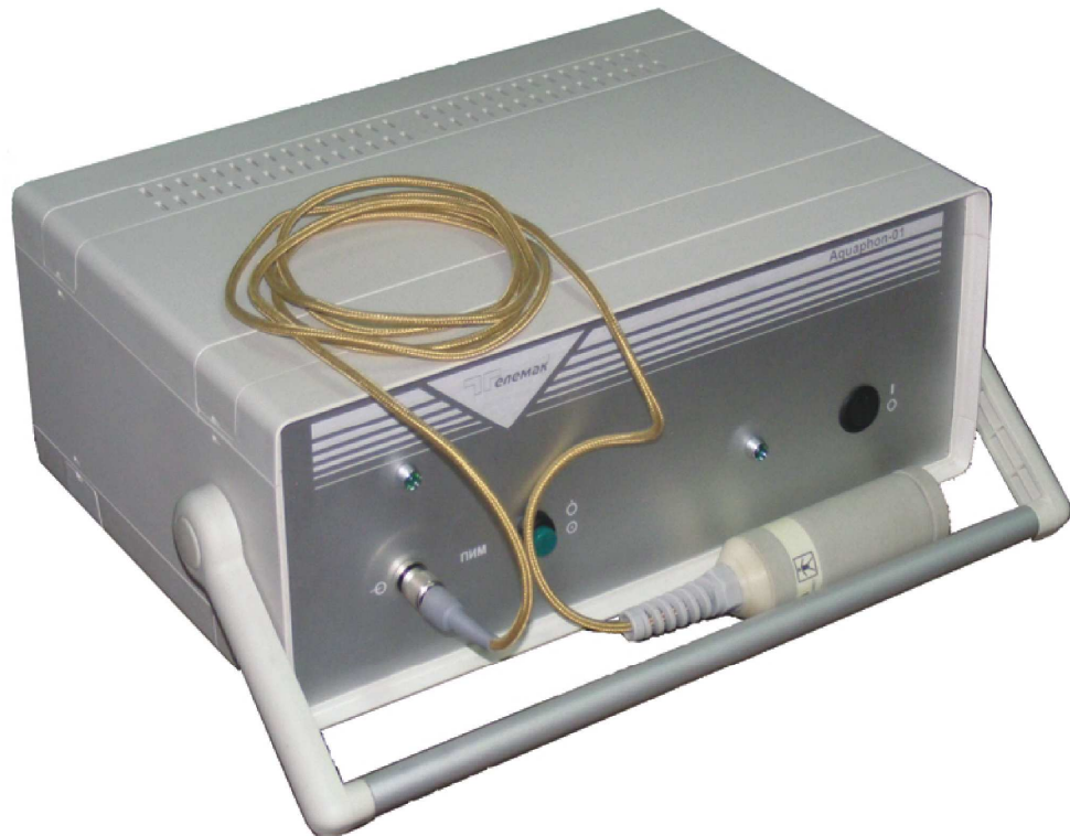
Рис. 20. Общий вид диагностического прибора «Аквафон» с приемно-излучающим модулем.
